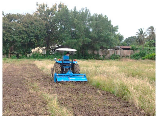
Hình 9b. Máy xới vùi rạ và cỏ trên ruộng khô
