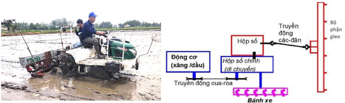
Hình 14. Máy sạ cụm và sơ đồ truyền động
