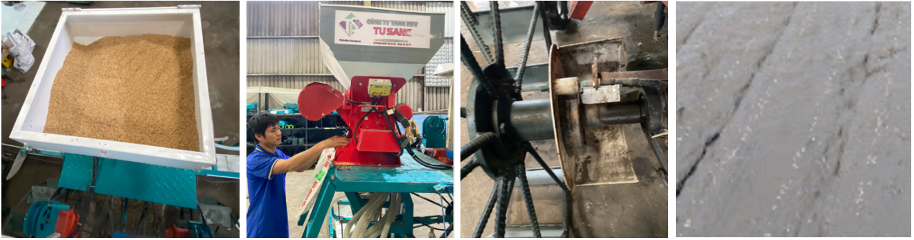
a) Cho giống vào bình chứa b) Kiểm tra lượng giống c) Kiểm tra cảm biến d) Kiểm tra sau khi gieo hạt
