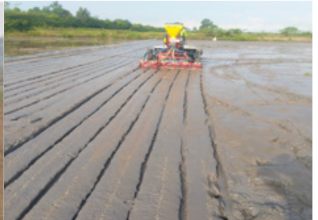
Hình 3c. Máy sạ hàng ruộng ướt
