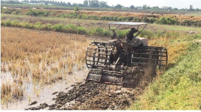
Hình 9c. Máy xới vùi rạ và cỏ trên ruộng ướt
