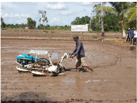
Hình 4a. Máy sạ cụm đi bộ
