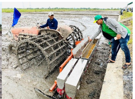
Hình 4c. Máy sạ cụm kết hợp vùi phân
