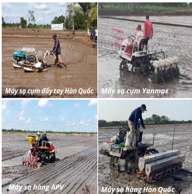
Hình 13. Một số máy gieo hạt ruộng ướt điển hình được thử nghiệm tại ĐBSCL
