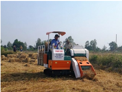
Hình 26. Máy cuốn rơm tròn tự hành (trái) và Máy thu gom rơm rời (phải)
