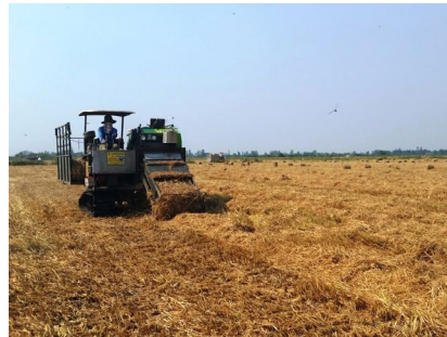
Hình 26. Máy cuốn rơm tròn tự hành (trái) và Máy thu gom rơm rời (phải)
