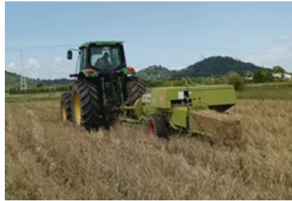
Hình 25b. Một máy cuốn rơm kiện vuông đang hoạt động trên ruộng.
