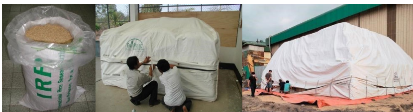
Hình 21. Túi bảo quản kín (hermetic bag) của IRRI chứa 50kg (ảnh trái), Túi Cocoon™ sức chứa 5t (ảnh giữa), và Túi Cocoon 300t (ảnh phải).
